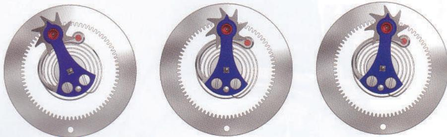
制动石一旦从星形轮上滑脱(左图)，星形轮逆时针转动(中间图)，直至下一个尖齿又被制动石阻挡住(右图)
