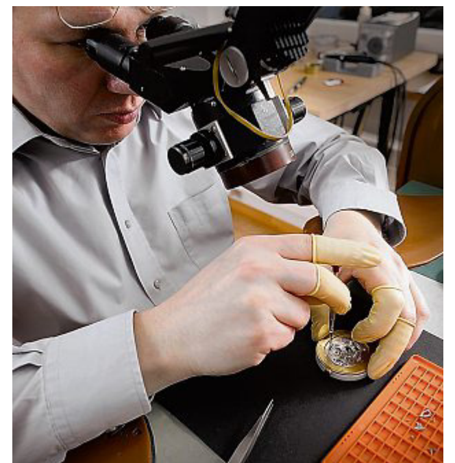
Viele Arbeiten werden unter dem Mikroskop ausgeführt. Während der Arbeit mit den Feinteilen werden «Fingerlinge» getragen, um die Teile vor Schmutz zu schützen.
