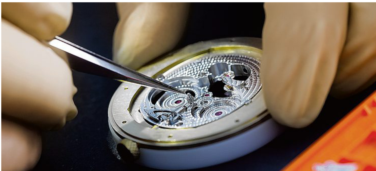
Viele Arbeiten werden unter dem Mikroskop ausgeführt. Während der Arbeit mit den Feinteilen werden «Fingerlinge» getragen, um die Teile vor Schmutz zu schützen.
